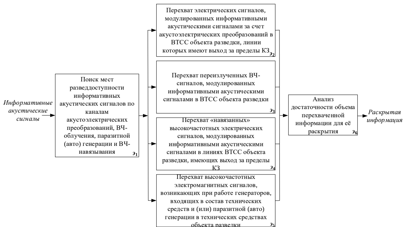
Рис. 1. Обобщенная функциональная модель угроз утечки информации по каналам, образуемым путем изменения параметров элементов РЭУ
