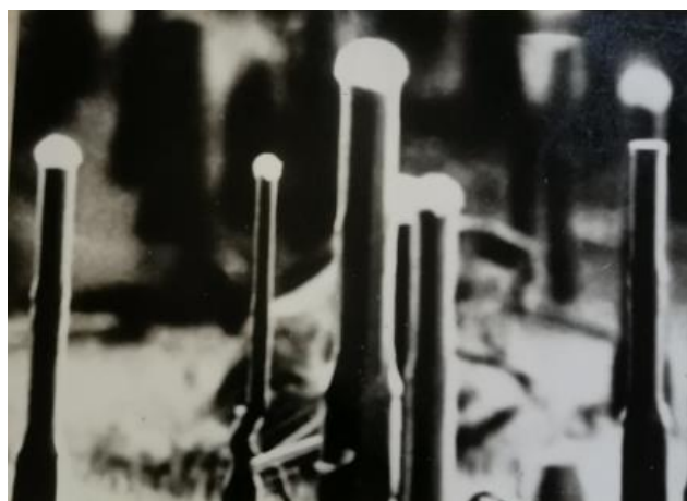
Рис. 2. Ориентированная система НК кремния с метками времени, выращенная с использованием Си в качестве иницилирующей ПЖК-рост примеси
